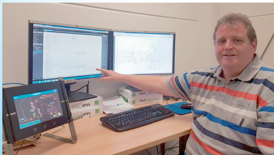
Nadat plc en touch panel zijn geprogrammeerd wordt de werking gesimuleerd en getest.
