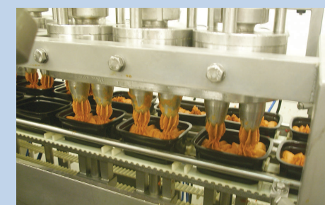
Elke 2 seconde worden 6 bakjes ingevoerd, gevuld met filet american en doorgevoerd.
