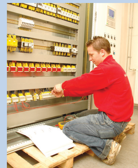
Sjon sluit de laatste bedrading aan van een schakelkast voor een ijzergieterij in Duitsland.
