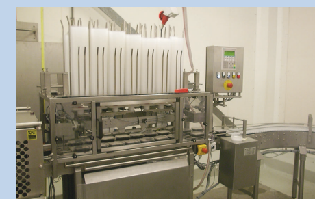
Bij de deksellijn worden 14 bakjes tegelijk automatisch voorzien van een deksel.
